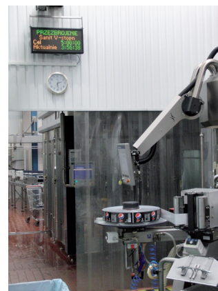
Zdj.1. Monitorowanie przebrojeń z wykorzystaniem tablicy Vorne XL800. Źródło: PEPSI General Bottlers Zakład w Michrowie. (8968)
